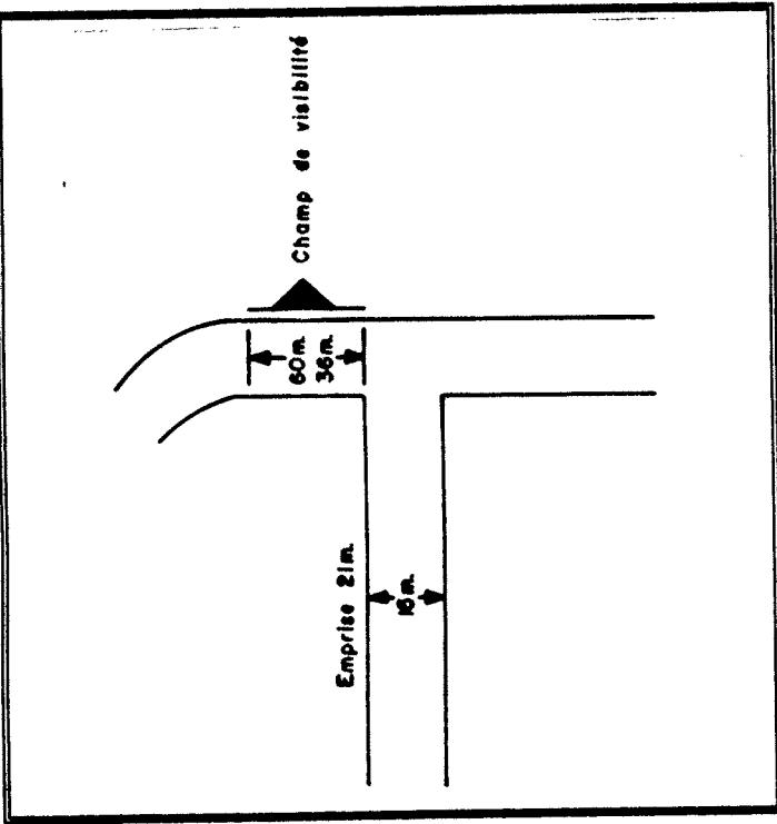
Les axes de deux intersections de rues débouchant sur une autre rue doivent être à une distance minimale de 60 mètres.
